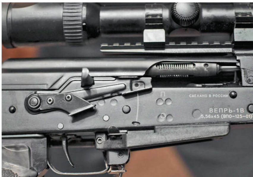
Затвор стоит на импровизированной затворной задержке
