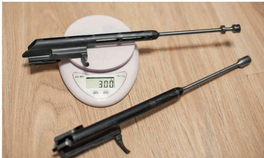
Облегчённая затворная рама в сборе с титановым поршнем рядом с оригиналом
