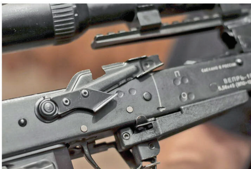
Доработанный флажок предохранителя и увеличенным упором под указательный палец и вырезом неавтоматической затворной задержки
