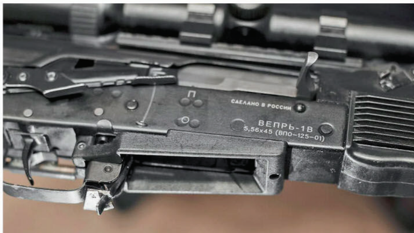
Была установлена направляющая шахта для магазина
